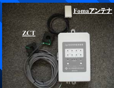
絶縁監視装置設置による 漏電の監視
