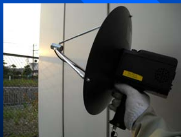
ウルトラホン(集音器)による 微小放電の測定
