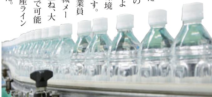
1分間に500本の製造が可能なペットライン。小型から大型ボトルまでを1つのラインで対応しています。
