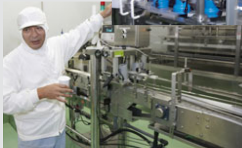
1分間に120個の製造が可能なカップライン。飲料からデザートまでさまざまなタイプの容器に対応しています。
