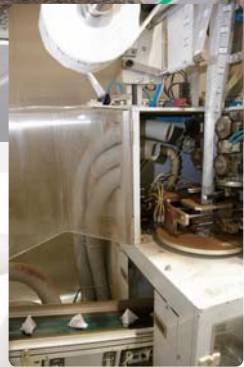
▲【加工】 ティーバッグに茶葉を詰め 成形しているところ。
