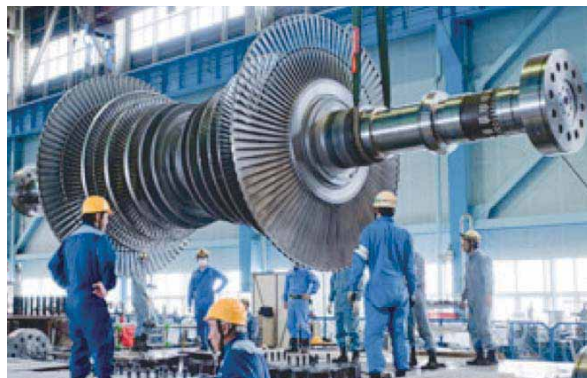
海南発電所2号機 蒸気タービンロータ
