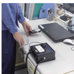
オフィスの照度測定
