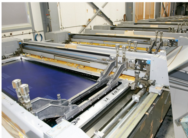
自動スクリーン捺染機。全長20mを超す長いベルトの上に色数分の型枠が正確に並べられ、次々と染料がすり込まれていきます。
