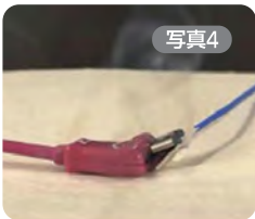
内部が変形したコネクターを使い続けたために温度が上昇して発煙。
