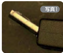
変形したコネクターの外観。
