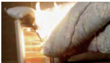
写真2 電気ストーブに接触して燃える布団(再現実験)
