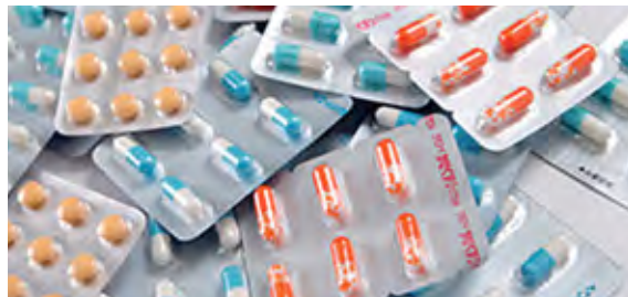
PTP (press through pack) 包装：錠剤やカプセル製剤をプラスチックとアルミで挟んだシート状の包装。
