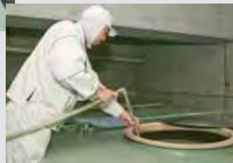
タンク内の温度ムラをなくす攪入れ作業。
