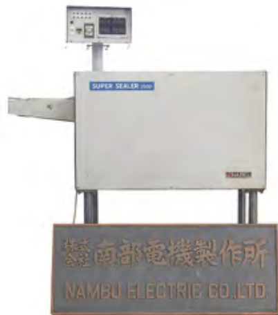
ナベルの鶏卵システム開発を加速させる契機となった「超音波シール機」。(1975年当時のもの)
