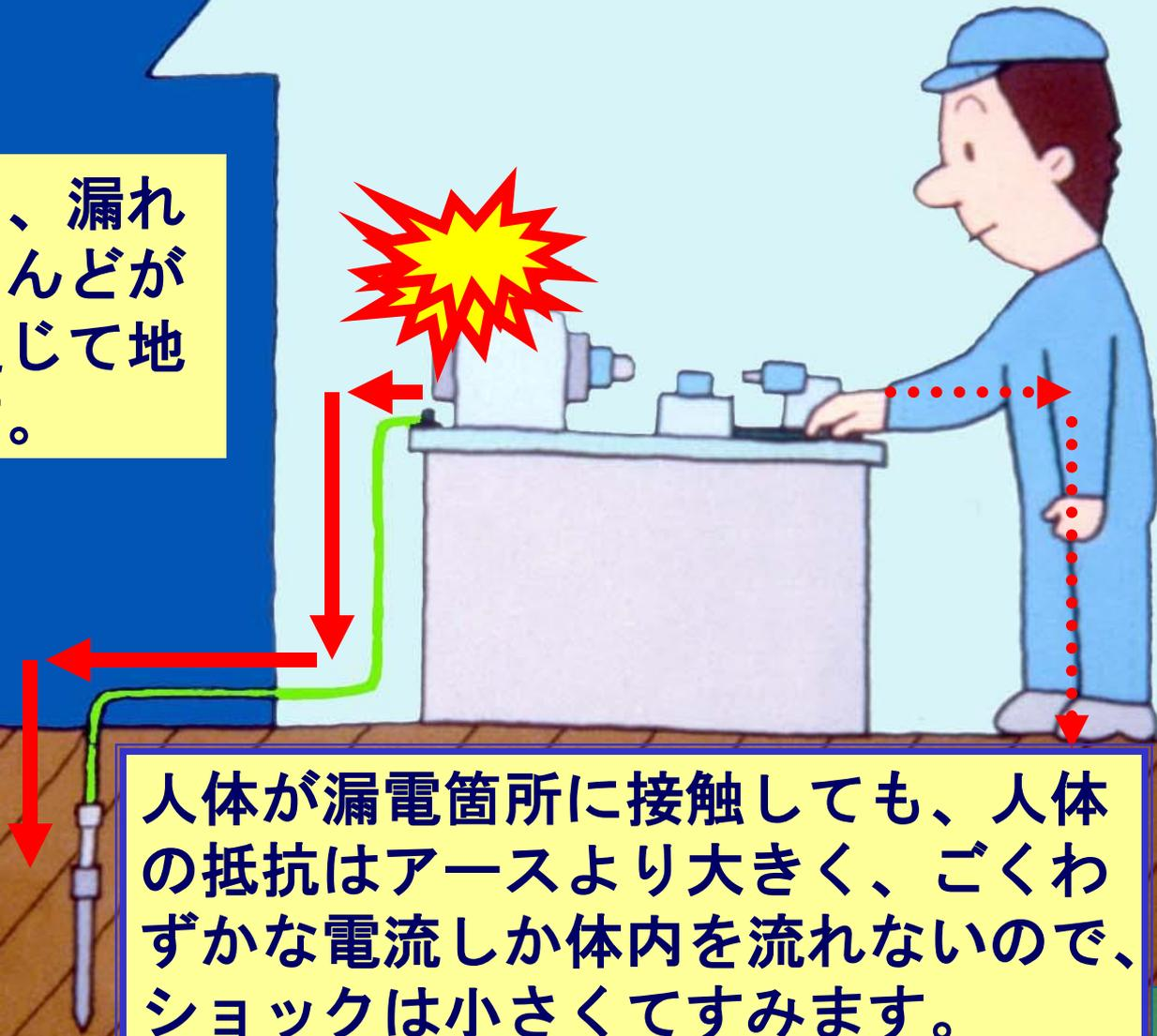
人体が漏電箇所接触到しても、人体の抵抗はアースより大きく、ごくわずかな電流しか体内を流れないので、ショックは小さくてすみます。
