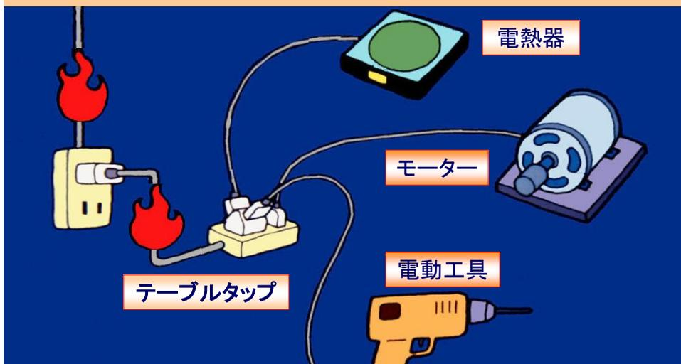
電線、コードなどは非常に熱くなり、そのため絶縁物が柔らかくなり、劣化が急に進み、ついにはショート(短絡)し、発火して電気火災や火傷の原因となります。
