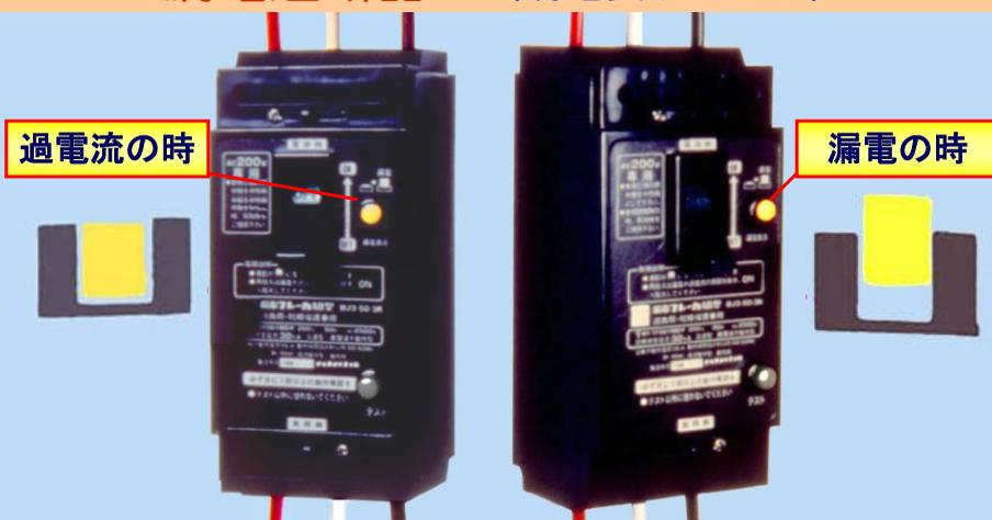
漏電遮断器には、漏電を遮断する機能と、ショートなどの際の大きな電流を遮断するブレーカの機能を一体化したものがあります。動作した時は、電流の流れ過ぎか、漏電の区別をしっかりと確かめて対処することが必要になります。
