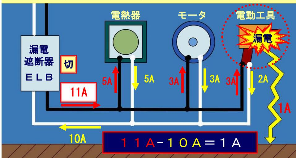
漏電が生じると、配線の帰りの電流が少なくなり、行き帰りに差が生じます。漏電遮断器は、この電流の差を素早くキャッチし、電源を切って感電を防ぎます。
