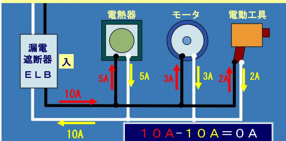
電熱器やモータなど負荷に送られる電流と帰りの電流を、配線の根元でたえず監視していて、漏電があれば自動的に電気を切る装置です。漏電のない配線では、送りと帰りの電流は等しく、つまり差は0Aとなります。
