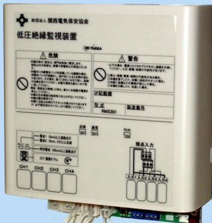
24時間365日、高精度に漏電を監視し、お客様の事業所のどこかで漏電が発生すると、関西電気保安協会に自動通報します。お近くの担当事業所から保安技師が出動し、漏電の原因を調べます。
