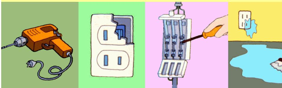
漏電遮断器が働く原因は、電気機器やコンセント、スイッチ、配線などの絶縁が悪かったり、充電部分に不注意に触れたり、また床洗いの際の水滴がコンセントにかかるなど、いろいろな場合があります。
