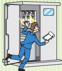
屋上のキュービクル内の不良箇所を確認する為に、高圧側の扉を開けました。内部の機器をよく見ようと体を近づけた時、つまずいて体がふらつき、左手が高圧交流負荷開閉器(LBS)の負荷側に接触し、左手の指先から左肘にかけて電流が流れ感電してしまいました。幸いにも指先の火傷だけの軽傷ですみました。
