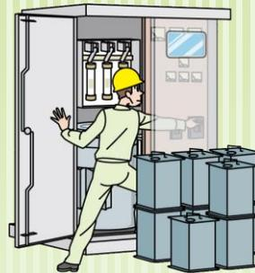
投入後キュービクルから出るとき、誤って頭上の高圧交流負荷開閉器(LBS)の負荷側に額が触れ感電し、キュービクル外にうつ伏せに倒れた。
