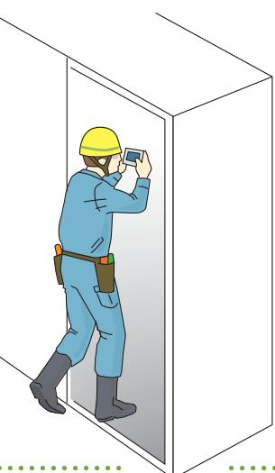
電気管理技術者（被災者）は、電気設備の機器台帳を作成するため、VCT（計器用変成器）の銘板をカメラで撮影しようと、充電中のキュービクル内に入った。
