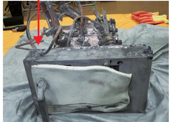
②真空遮断器には1年に1回の定期点検の実施が義務付けられており、その際、保守点検(清掃、注油、絶縁抵抗測定等)を実施する必要がありますが、これら3件の火災・事故すべてにおいて、保守点検未実施、もしくは前回点検時に電源を遮断しての絶縁抵抗値の測定は実施されていませんでした。
