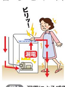
図1 漏電による感電
