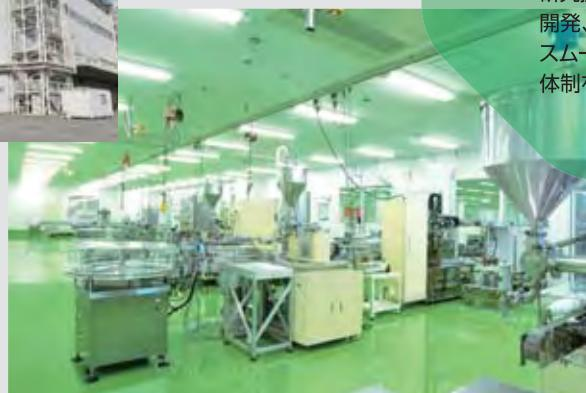
ISOの化粧品GMP(製造・品質管理基準)に適合した各工場には、大量生産が可能な真空乳化装置や、各種充填設備を保有しており、化粧水・クリーム、乳液などの幅広い製品が製造されています。
