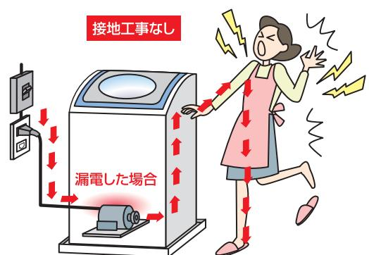
図5 漏電による感電のしくみ
