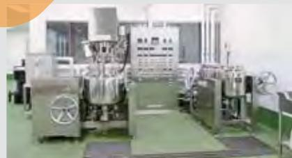
大小さまざまなサイズの真空乳化装置が並ぶ研究所。製剤化のための段階的な試作検討が行われています。
