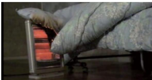
写真4 ふとんがストーブに触れた16分30秒後に着火(再現実験)
