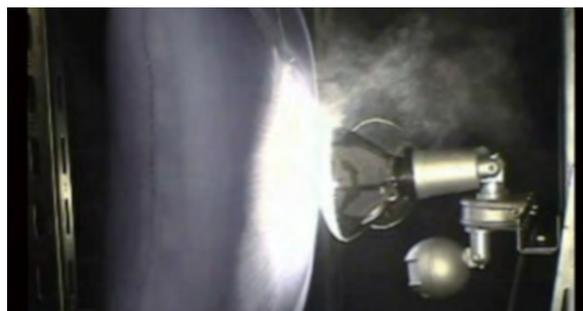
写真5 センサーライトに接触して燃えるふとん(再現実験)
