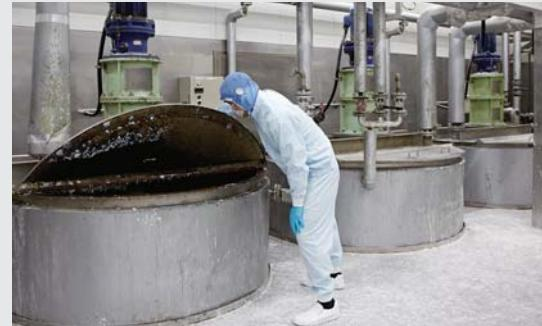
原料を加熱、攪拌する釜。熟練した社員が天候や湿度によって時間や水分量などを微調整し、石けん素地を仕上げる。
