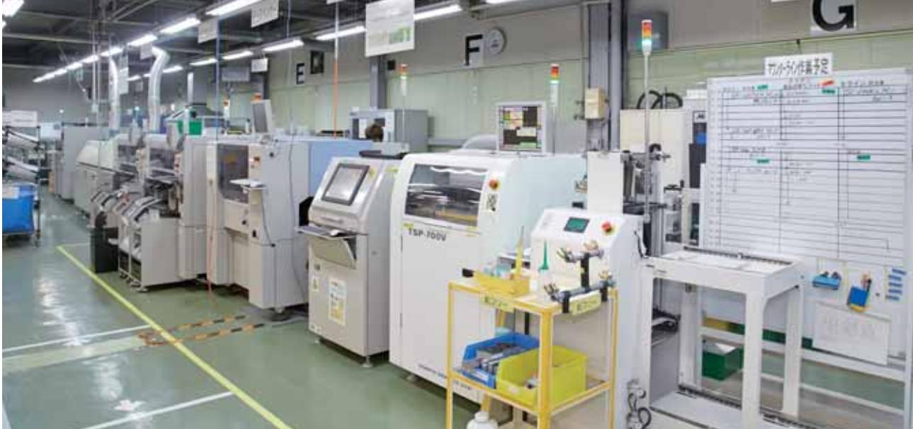
基板上の集積回路に電子部品を取り付ける(基板実装)Aライン。
