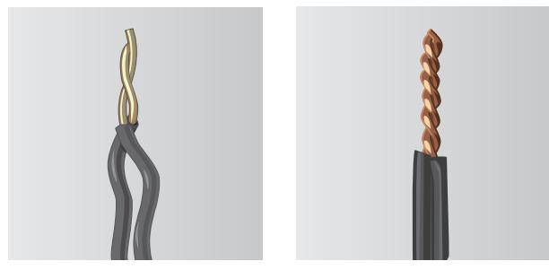
図7 接触不良箇所の配線状態
