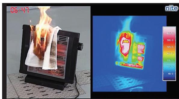
写真1 電気ストーブ上に落ちて燃える洗濯物(再現実験)
