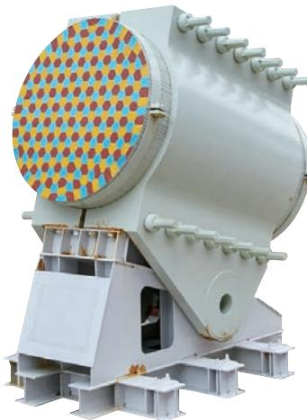
明石海峡大橋を吊るケーブルの実寸模型。1本で車4台を吊り上げられる強度を持つ特殊な5mmのワイヤーを127本使って六角形の束をつくり、さらにそれを290本まとめます。全部で37,000本のワイヤーがひとつになり直径約1mのケーブルになっています。
