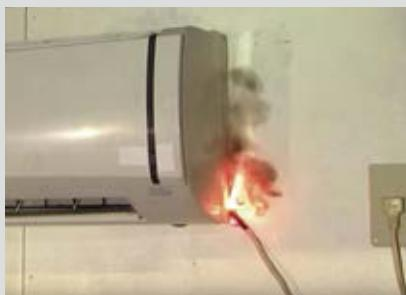
【写真3】エアコンの電源コードのねじり接続による発火
