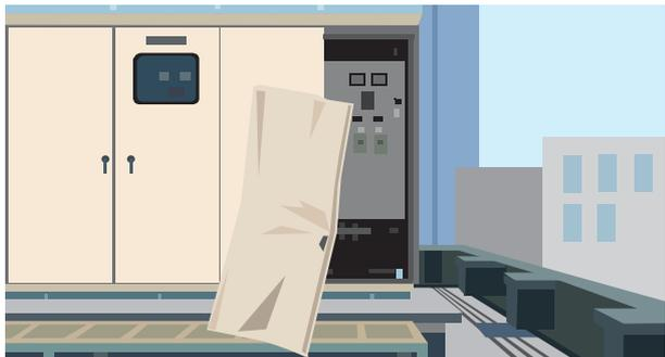
図3 強風により破損したキュービクルの扉
