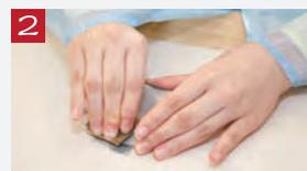
錫が冷めるまで待ち、型からきれいに外します。サンドペーパーと耐水ペーパーで磨き、最後に研磨剤を使って仕上げます。
