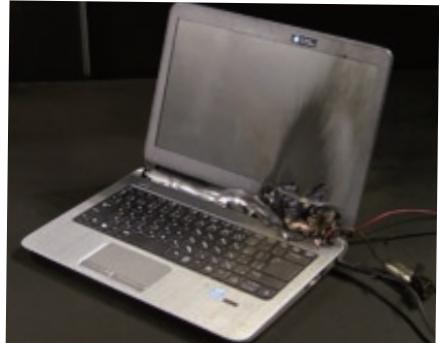
非純正バッテリーの使用で発火、焼損したノートパソコン
