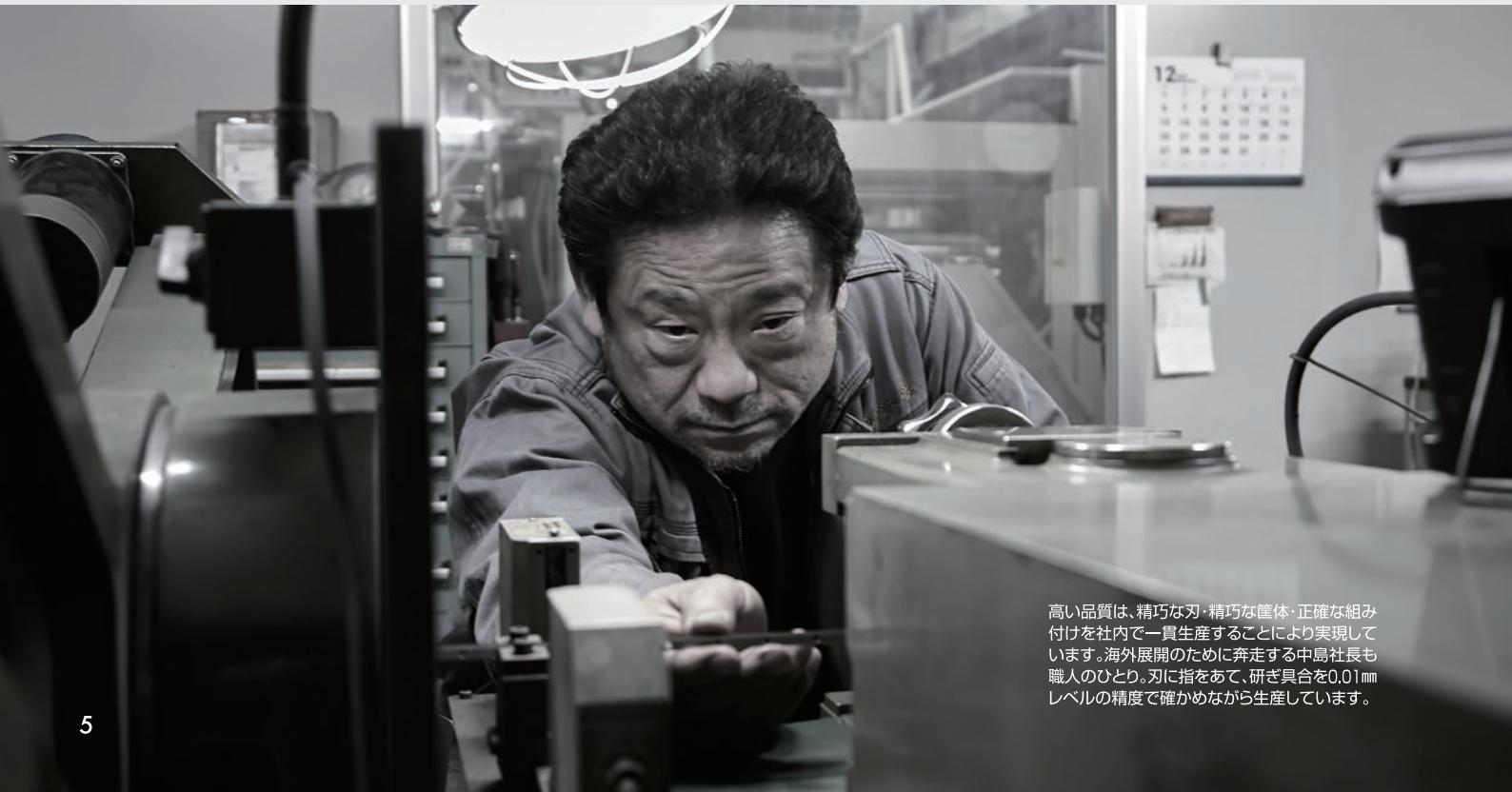
高い品質は、精巧な刃・精巧な筐体・正確な組み付けを社内で一貫生産することにより実現しています。海外展開のために奔走する中島社長も職人のひとり。刃に指をあて、研ぎ具合を0.01mmレベルの精度で確かめながら生産しています。
