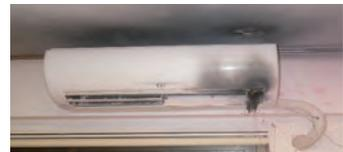
そこで、エアコンの製造業者と合同で製品鑑識を実施しましたが、エアコン内部のアース線に過電流による焼損が認められるものの、基板や接続部に異常はなく、結果的にはエアコンの不具合により出火したものではないとの見解に至りました。
