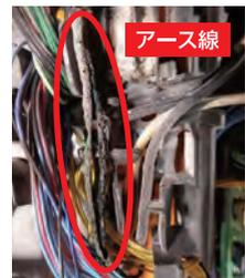
再度、視点を変えて調査を続けます。火災建物は工事用シートが張られ、火災当日を初日として、屋上で「アーク溶接」作業をしていました。
