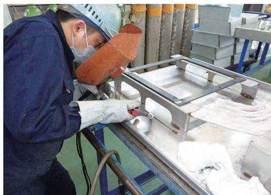
写真4 屋根の溶接の様子
