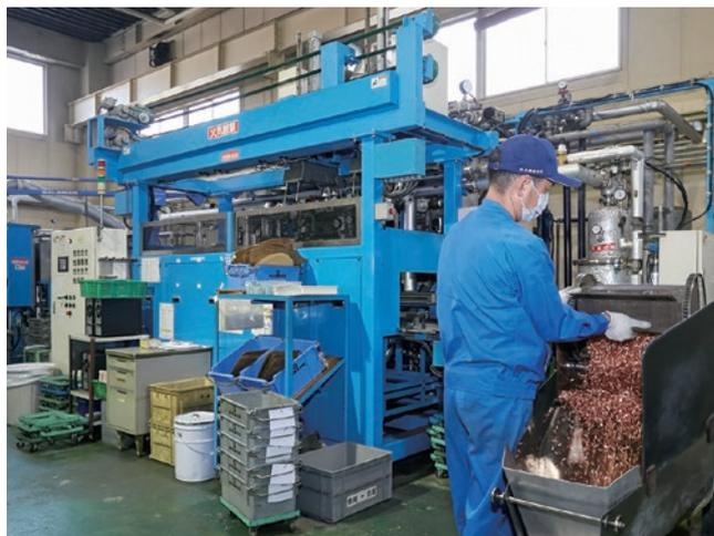
〈超音波自動洗浄機〉超音波で油を洗い落とします。
