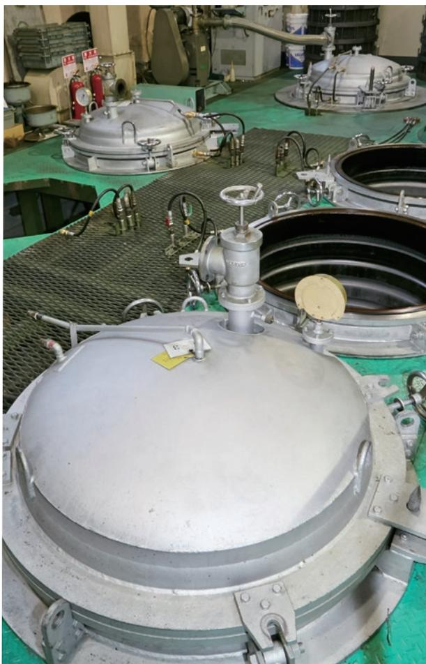
〈真空焼鈍炉〉熱を加えて銅を柔らかくします。真空なので均一に熱が伝わります
