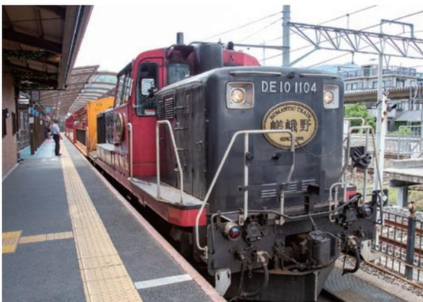
トロッコ列車を引っ張るDE10形ディーゼル機関車は、日本各地のローカル線で、蒸気機関車に換わる動力近代化を担った中型機関車です。
