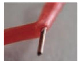
破断した銅メッキ鉄線
