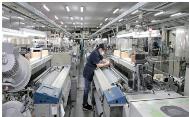
工場内には、圧縮した空気の方でヨコ糸を通す最新のエア織機がずらりと並び、見る間に生地が織り上げられています。
