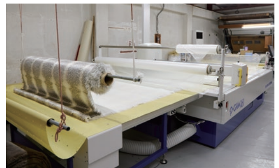
毛がカットされずに、生地のみを裁断できる裁断機を地元・和歌山の株式会社島精機製作所に依頼し導入。隠れたニーズを掘り起こした裁断は、2年先まで受注が埋まっています。
