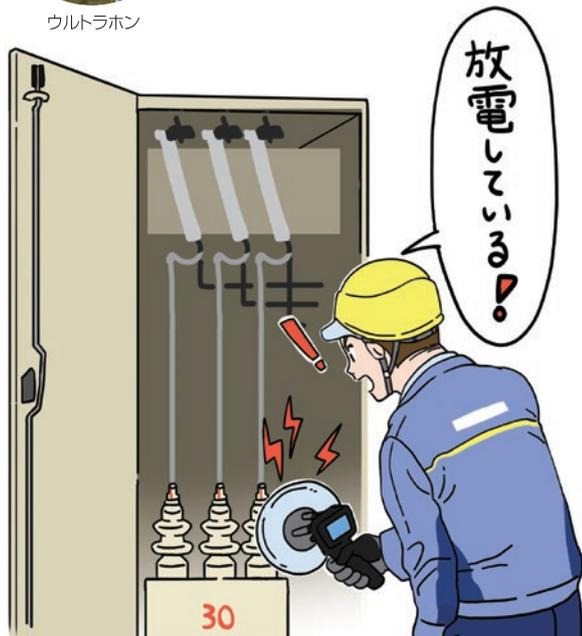
コンデンサの絶縁状態を確認するためにお客さまへ現状をご説明し、業務終了後に停電し確認したい旨をお伝えし了解いただきました。停電してコンデンサ本体の絶縁測定を実施すると絶縁抵抗値が著しく低下
