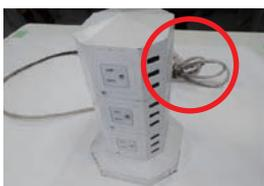
写真1 焼損した電源タップ
