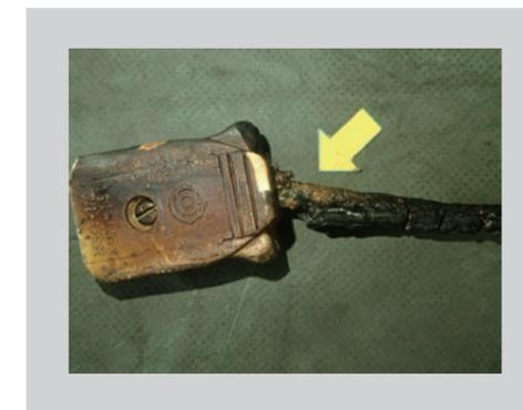
写真2 焼損した電源タップ
