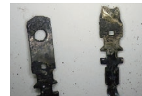
写真2 溶断したプラグの差し刃
