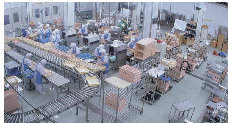
徹底した衛生・品質管理のもと、人による作業のバラつきをできる限りなくすためにオートメーション化された生産ライン。1日最大10万食の柿の葉すしが製造可能です。
