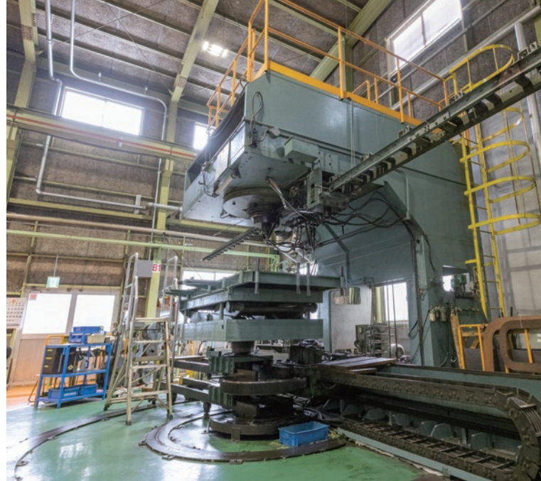
最大内径寸法3000×800ミリメートル、巻線の厚み20ミリメートルまでのエッジワイズコイルを製造できる国内最大級の大型巻線機。
