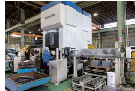
最も大きな500tプレス。コア板の打ち抜きに用います。
