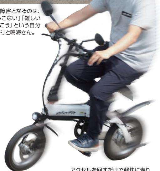
アクセルを回すだけで軽快に走り出します。最高時速は30km/時。
