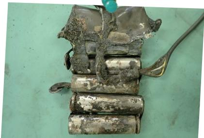
図1 焼損したコードレス掃除機の互換性バッテリー
