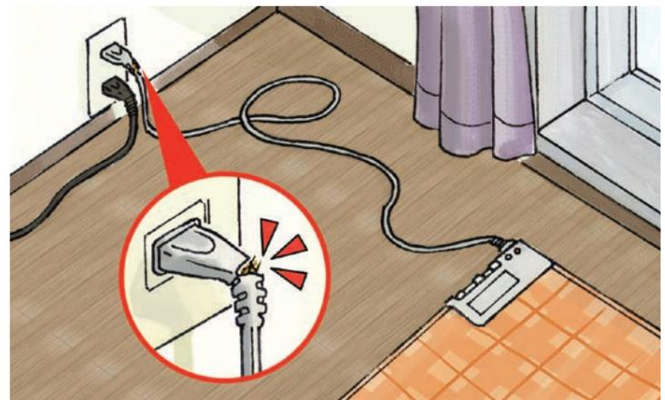
電気カーペットのコードプラグ付け根付近が半断線状態になり、出火に至ったもの。
