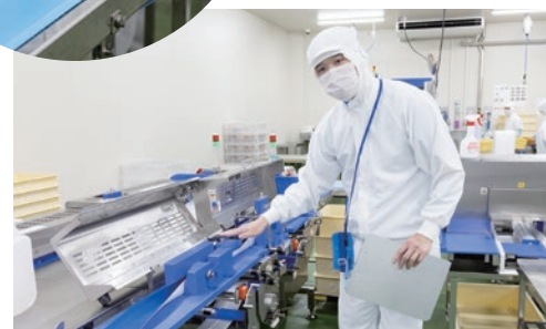
大量ののり巻きを均一に、効率よく製造できるのり巻き成型機。美しくスピーディーに盛りつけるのは、担当スタッフの技術です。
