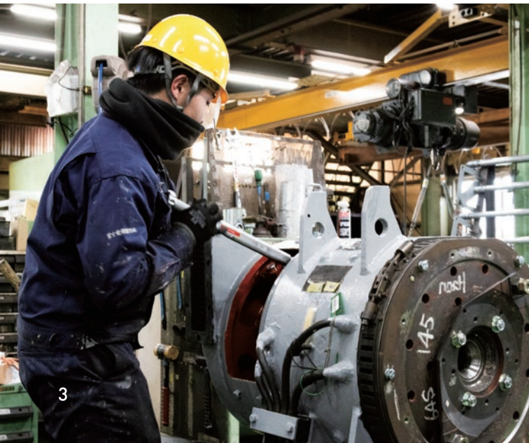
▼組み立てたモーターにゆるみなどがなければ、確認しながらの締め付け作業。
