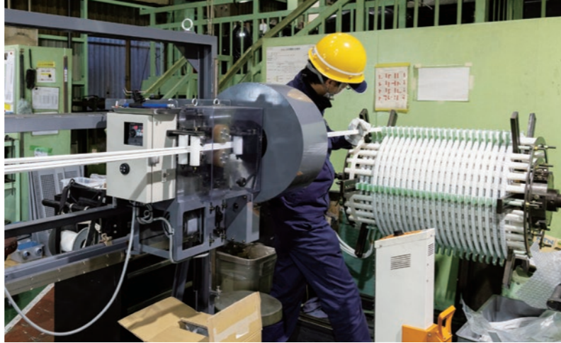
▲リアクトルコイルの巻き替え。複数の電線を巻線機により均等に巻き取ります。
