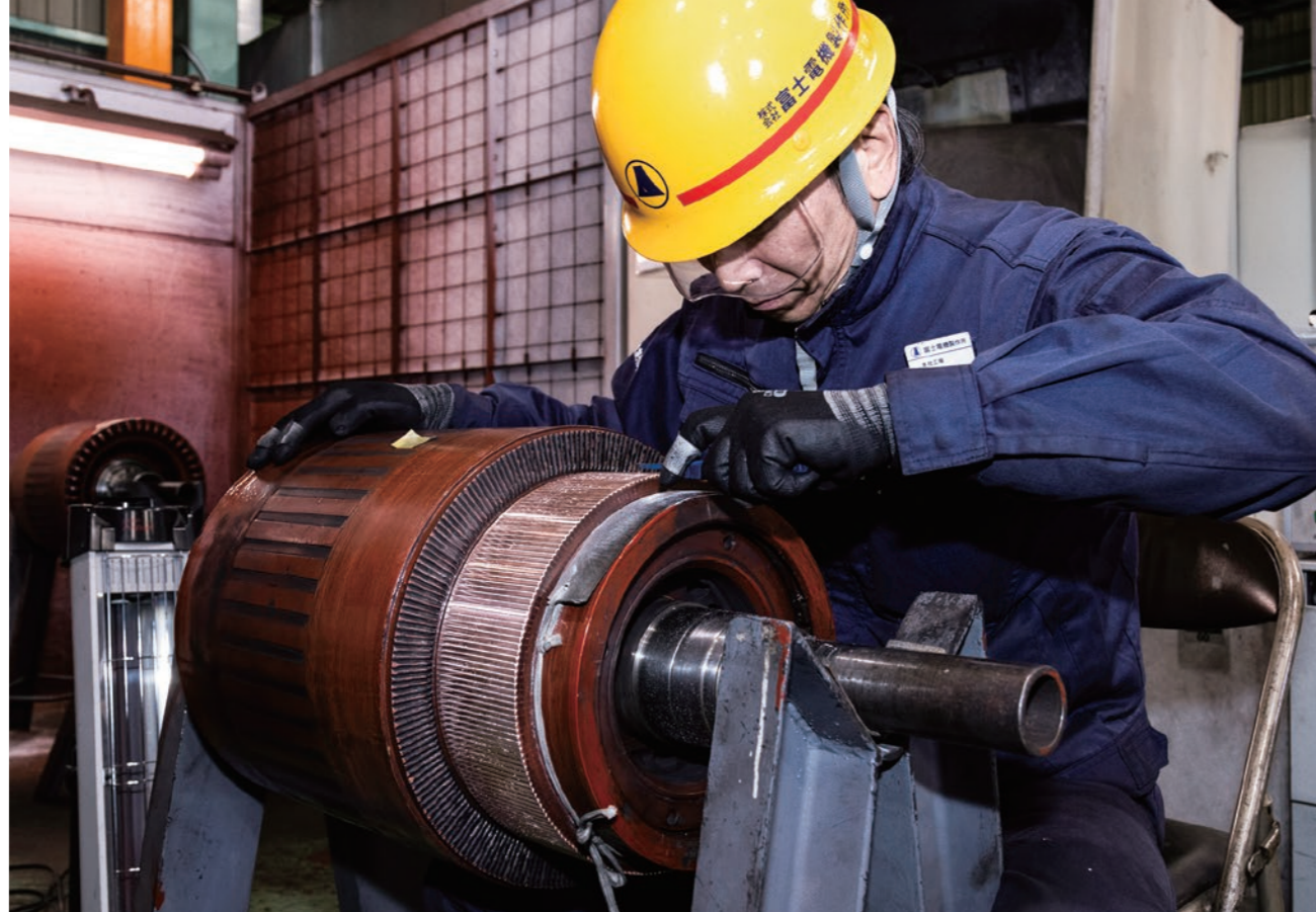
直流モーターの整流子のメンテナンス風景。電極との接触面を削って面状態を整えます。
