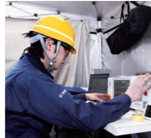
▲絶縁劣化試験。 部分放電の発生状況を測定中。
