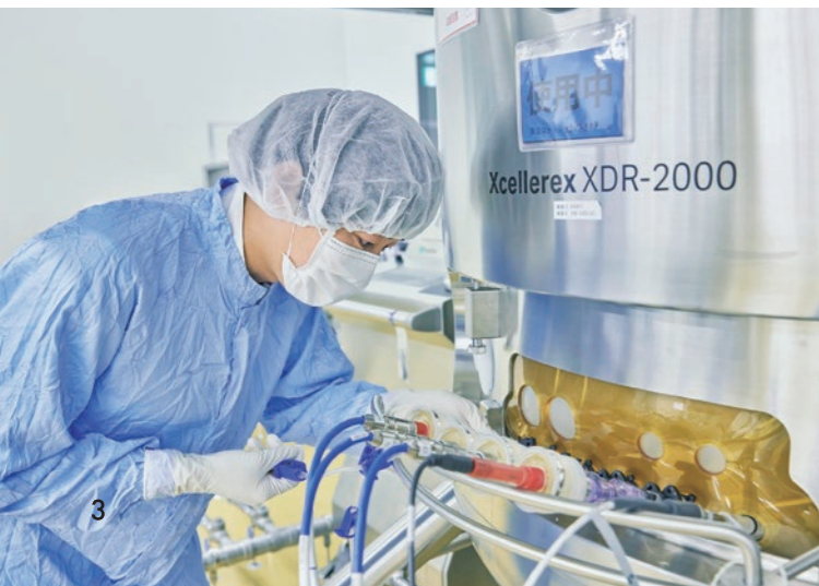
▼バイオ医薬品の細胞培養は、洗浄・滅菌が不要な使い捨てバッグを用いた、シングルユース技術の大型培養器で行います。
